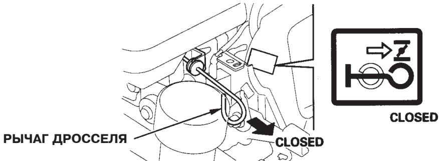
2. Рычаг управления с возможностью остановки двигателя:
